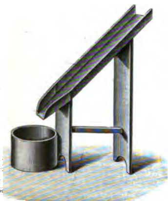
Fig. 40. — Plan incliné pour le remplissage d'un litre de ciment.
